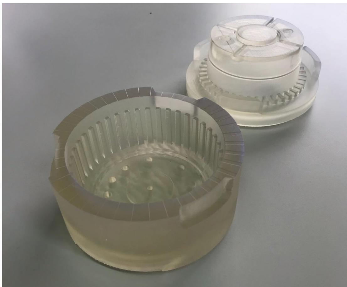
*Moule imprimé en Clear Resin pour injection de cire.*
