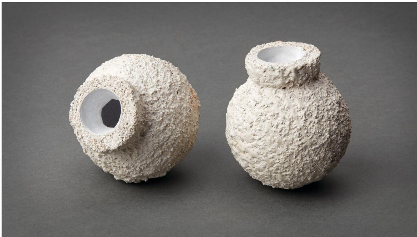
*Coque en céramique après le brûlage des modèles imprimés par SLA en Clear Resin.*
